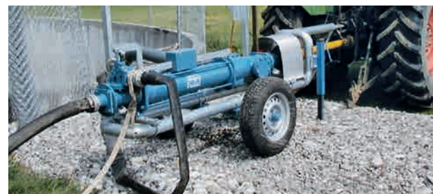
Hadicové propojení nádrže na kejdu s čerpadlem WANGEN výrobní řady GL
