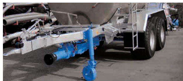
Náhonová čerpadla na cisternách na kejdu
