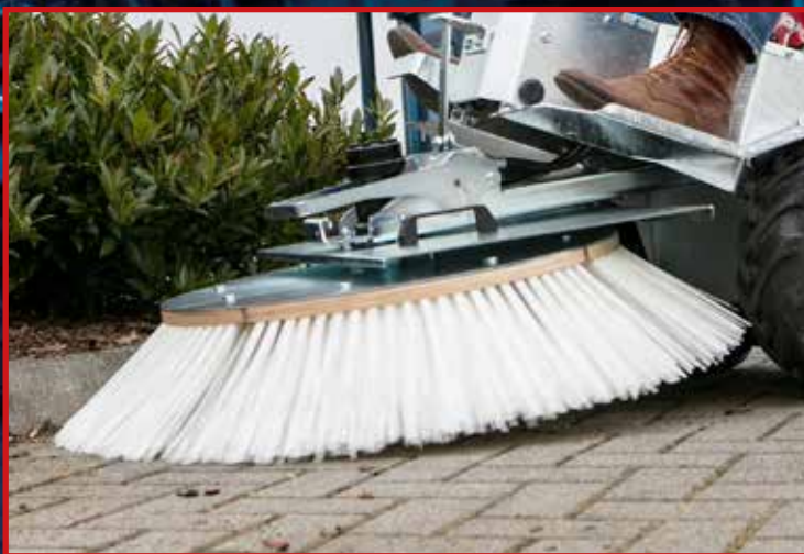
Abb.: Cleanmeleon 2 mit Radialbesen R 1000 (PPN-Bürste kl. Bild / Drahtbürste gr. Bild)
