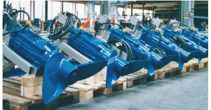
Vrtulová ponorná míchadla GTWS 1540 / 204 připravená k vyskladnění
