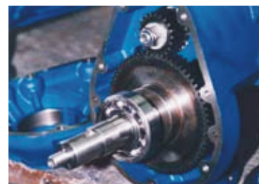
Složení převodovky u GTWS 740 / 1040
