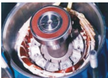
Stator (elektrické vinutí) a rotor pro GTWS
