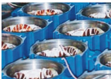
Elektrické vinutí (stator) vlisované do tělesa motoru
