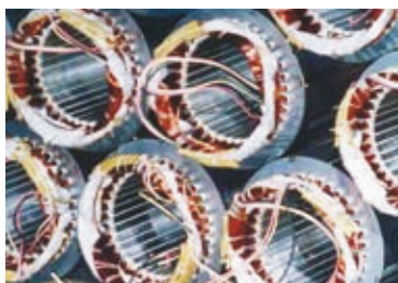
Elektrické vinutí (Do statoru složeného z plechů se vkládá třífázové vinutí)
