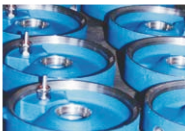
Ložiskové přírby s vestavěnou sondou těsnosti
