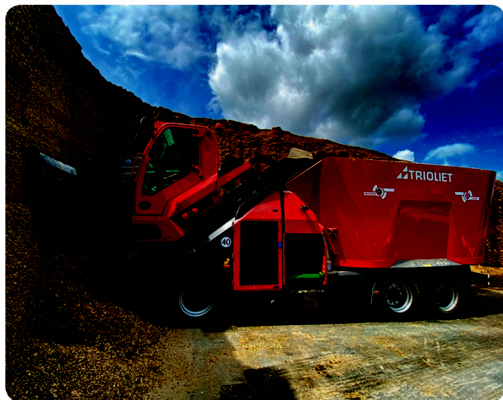
Řezací štít s aktivními protiběžnými noži na všech třech stranách vyřezává siláž nebo senáž, uvnitř štítu osazený odvalovací válec ji odhazuje na široký vynášecí dopravník a ten ji posouvá do míchací vany
