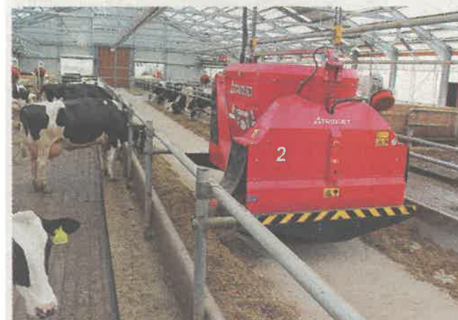
Na nové mléčné farmě krmit dojnice robot Triomatic HP 2-300
